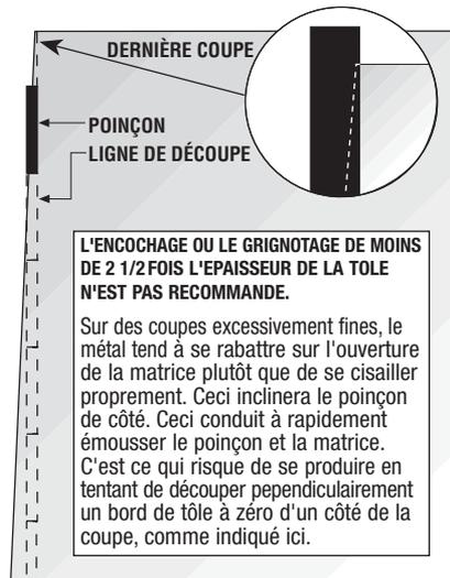
L'outil de refendage à dégagement de pinces Ultra est conçu pour compenser ces charges latérales et pressions de pivotement. L'avantage vient du guidage de la pointe du poinçon. En contrôlant fermement et perpendiculairement la pointe du poinçon au moment de son contact avec la tôle, il permet au poinçon de percer précisément un trou, même en cas de course partielle.
